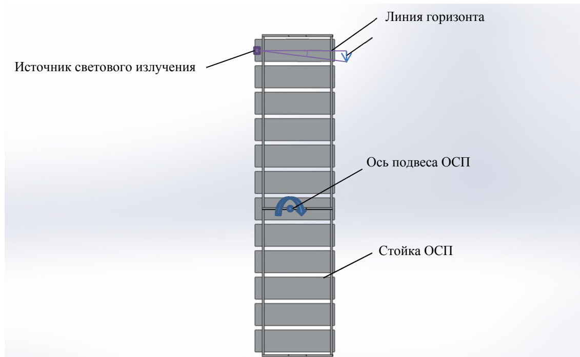
Рис. 4. Смещение светового луча в результате деформации конструкции
